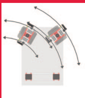
Achsschenkellenkung** Ackermann steering**
