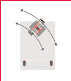
Achsschenkellenkung** Ackermann steering**
